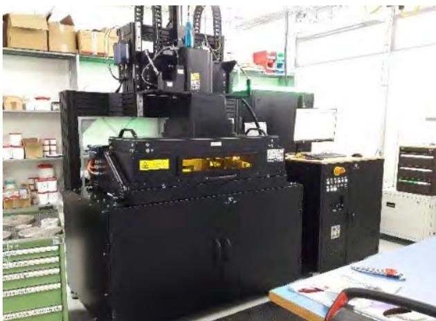
oder Keramiken, was insbesondere durch die Möglichkeit der Aufheizung der Bauplatte auf 1'000°C erreicht wird. Ergänzt wird dieses Portfolio durch ein integriertes Pyrometer, welches Auskunft über Prozesstemperaturen liefern kann, was vor allem in der Verarbeitung herausfordernder Materialsysteme von Bedeutung sein kann.
